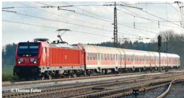
**Vorbild:** Elektrolokomotive Baureihe 147 (TRAXX AC 3 LM) und ohne Flex-Panel der Deutsche Bahn AG (DB AG). Gebaut von Bombardier als Serienlokomotive aus dem TRAXX 3-Typenprogramm. Betriebsnummer 147 009-5. Betriebszustand ab Dezember 2016.
