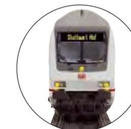
Bei schiebender Lokomotive leuchtet am Steuerwagen ein weißes Dreilicht Spitzensignal. Bei ziehender Lokomotive brennen am Steuerwagen zwei rote Schlusslichter.
