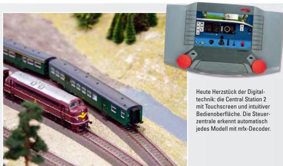
Heute Herzstück der Digitaltechnik: die Central Station 2 mit Touchscreen und intuitiver Bedienoberfläche. Die Steuerzentrale erkennt automatisch jedes Modell mit mfx-Decoder.
