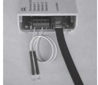
Verbinden Sie nun die weißen und grauen Litzen beider Sensoren entsprechend der Beschriftung mit den Anschlussklemmen des LISSY-Empfängers.
